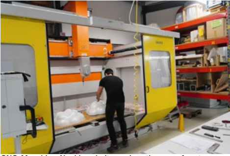
CNC-Maschine, Nachbearbeitung eines thermogeformten Objekts
