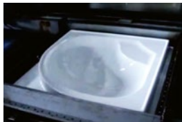
Sogwirkung mit Unterdruck (0:33)
