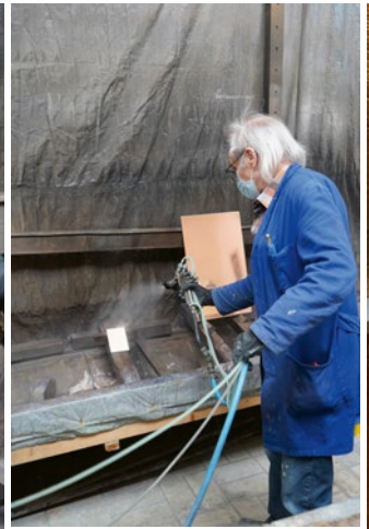
Auftrag der Kupfersulfatlösung
