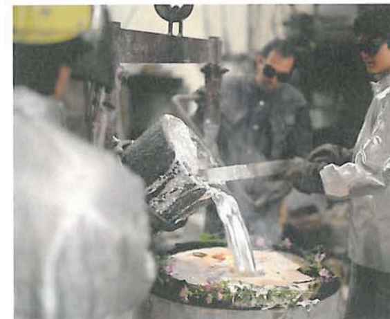
Giessereimitarbeiterin Michèle Elsener hält die Schlacke zurück, während das flüssige Aluminium in die Form einer Arbeit von Franziska Koch für einen Brunnen in Fribourg gegossen wird.
