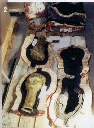
1 Philipp Bachmann schlägt Schamotte von einem Guss ab 2 Wachmodelle der Köpfe, die für den US-Künstler George Condo in Bronze gegossen werden 3 Carina Kirsch mit Wachplätzchen für Ugo Rondinones überdimensionale Glühbirnen 4 Stefan Inauen bearbeitet einen Guss 5 Sehen aus wie Rüben, sind aber Gipsgüsse von Urs Fischers Regentropfen 6 Antonia Möhr gießt Gips für die Regentropfen-Güsse in kleine Zylinder
